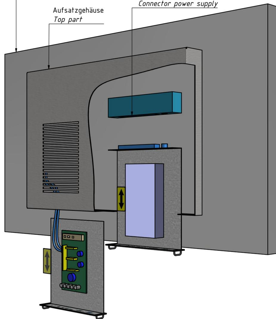
Service-Modul mit Ansteuerungselektronik und Kabel-Kupplung
